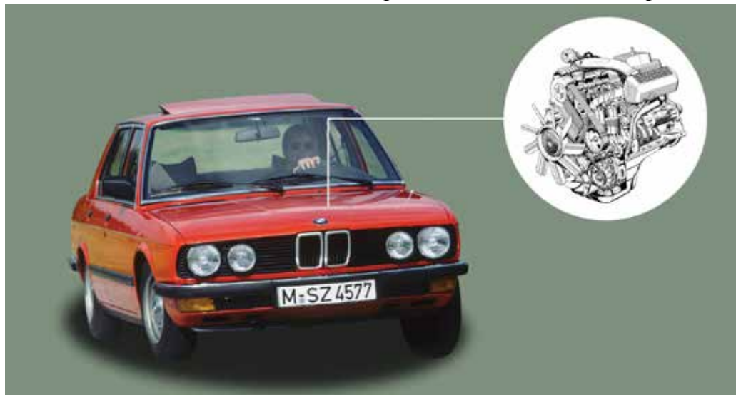
O BMW 524td era um sedã de luxo que utilizava motor de seis cilindros em linha a diesel, com potência de 115 cv
