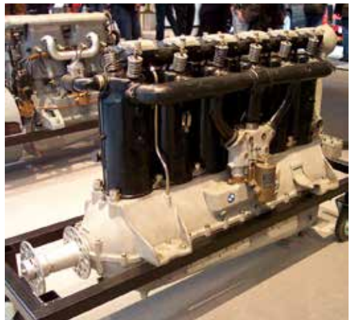
Motor BMW IV de seis cilindros com potência de 250 cv
