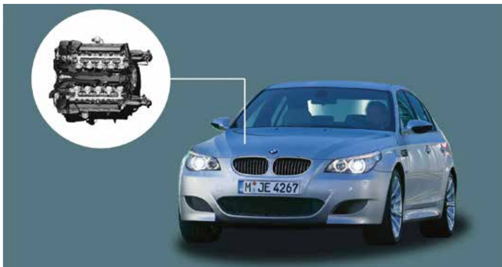
O motor de dez cilindros em V do BMW M5 de 2004 fornecia ao sedã a potência de 507 cv
