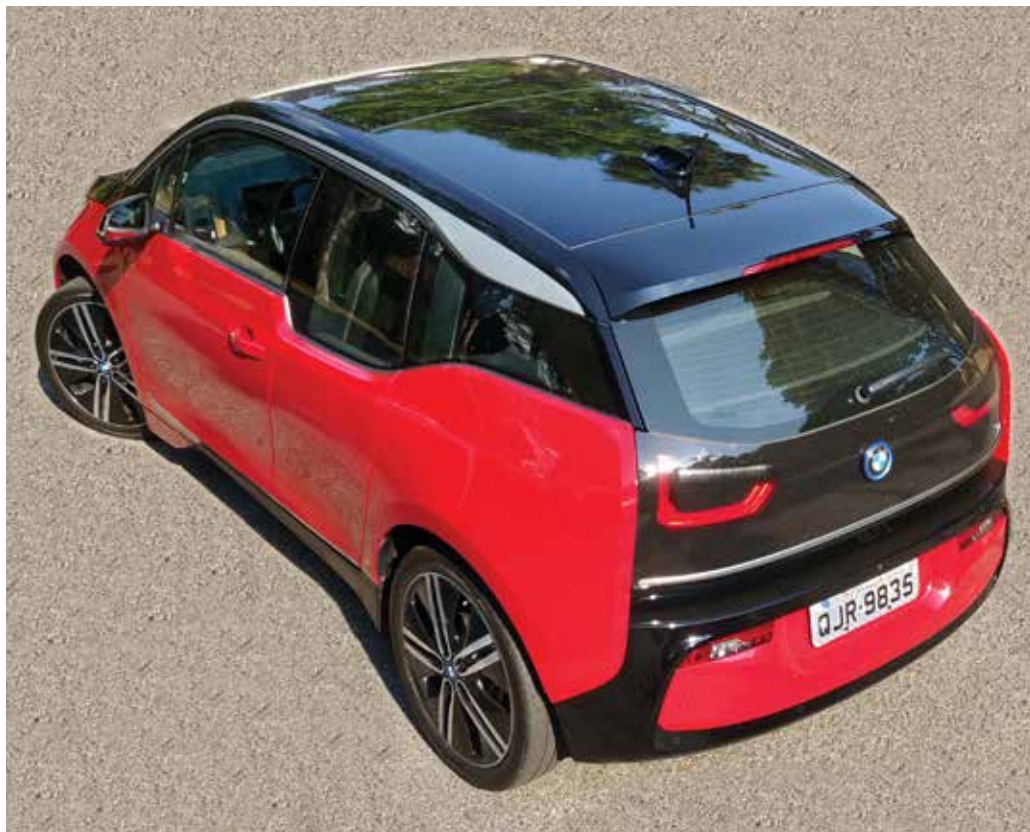
O BMW i3 tem motor elétrico de 170 cv, instalado no eixo traseiro
