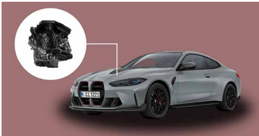
O BMW M4 CSL de 2022 usa o motor S58, um seis cilindros em linha de 550 cv de potência
